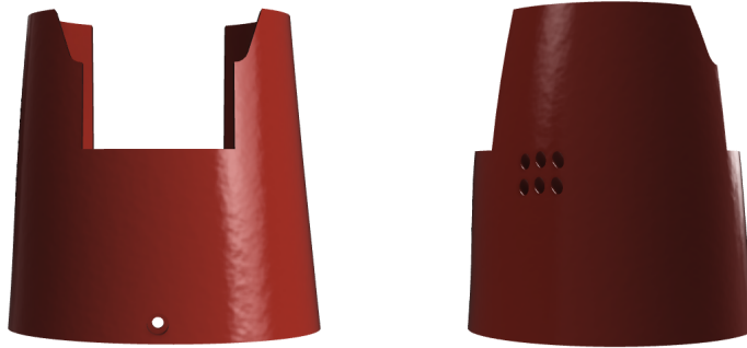
Figura 38: Pieza superior del antebrazo, a) vista frontal (izquierda), b) vista lateral (derecha). Elaboración propia
