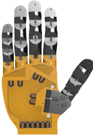
Figura 66: Diseño y disposición de la estructura para la palma, con una escala de 1.5 veces el tamaño real.
