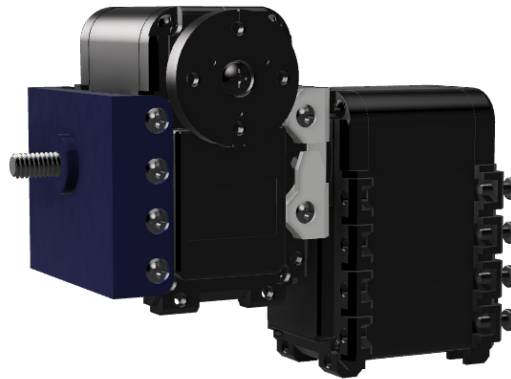
Figura 33: Ensamble del acople para el movimiento de desviación cubital-radial. Elaboración propia
