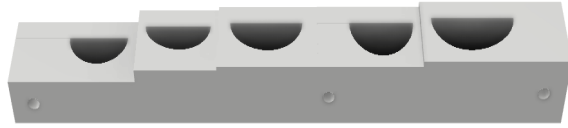
Figura 24: Molde para fabricar las yemas de silicona.
