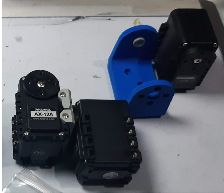
Figura 34: Ensamblaje de servomotores y acople muñeca-mano. Elaboración propia
