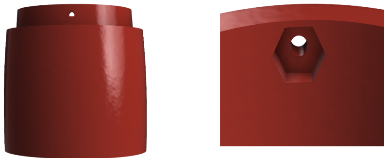
Figura 39: Pieza inferior del antebrazo, a) vista frontal (izquierda) y b) detalle de la cavidad para tuerca (derecha).
