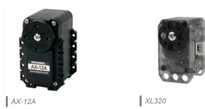
Figura 18: Servomotores utilizados, AX-12A (izquierda), XL-320 (derecha). [17] y [18]
