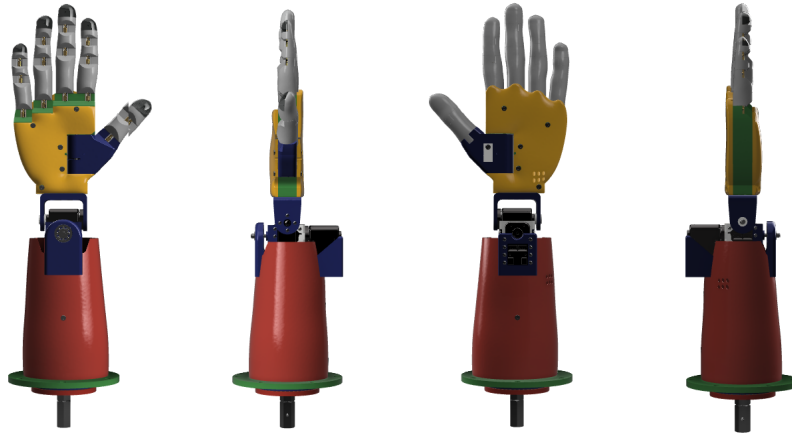
Figura 69: Vistas del ensamblaje de los dedos, palma, muñeca, antebrazo y base giratoria. Elaboración propia
