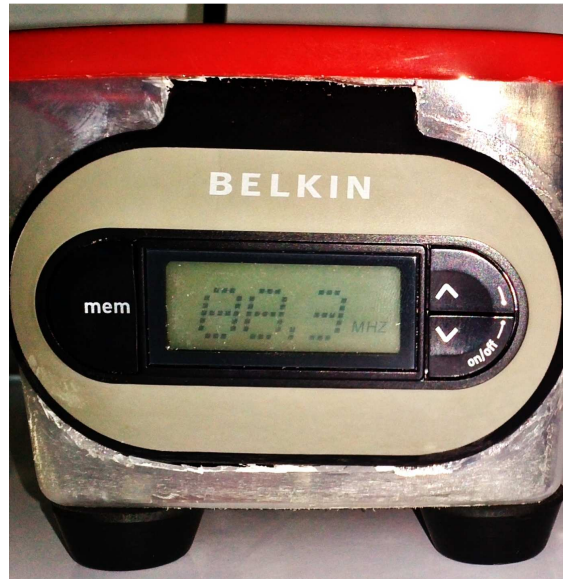
Figura 28. Transmisor sintonizado a la frecuencia de 88.3MHz 31
