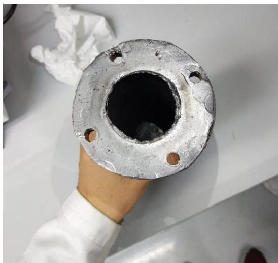
Figura 31. Carbón obtenido después del proceso de pirólisis extrema en el reactor para pirólisis
