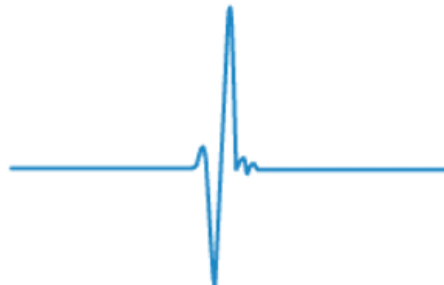
Figura 13. Interferograma de un espectrofotógrafo FTIR
