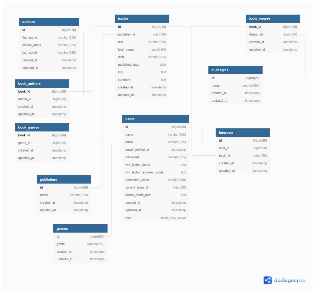
Figura 34 Estructura de base de datos utilizada
