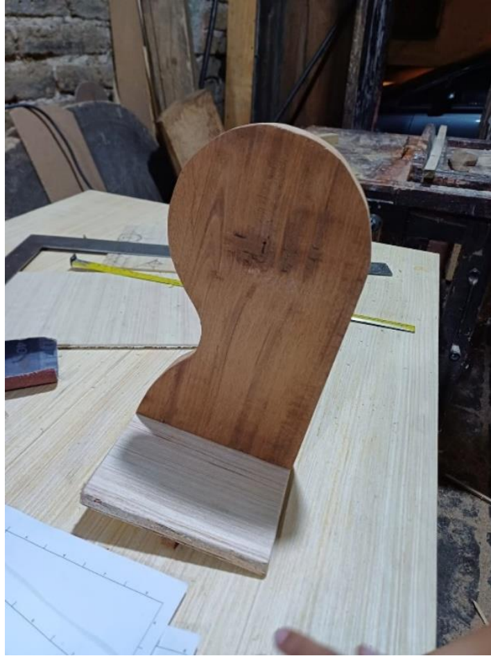
Figura 32. Corte y construcción de caballo
