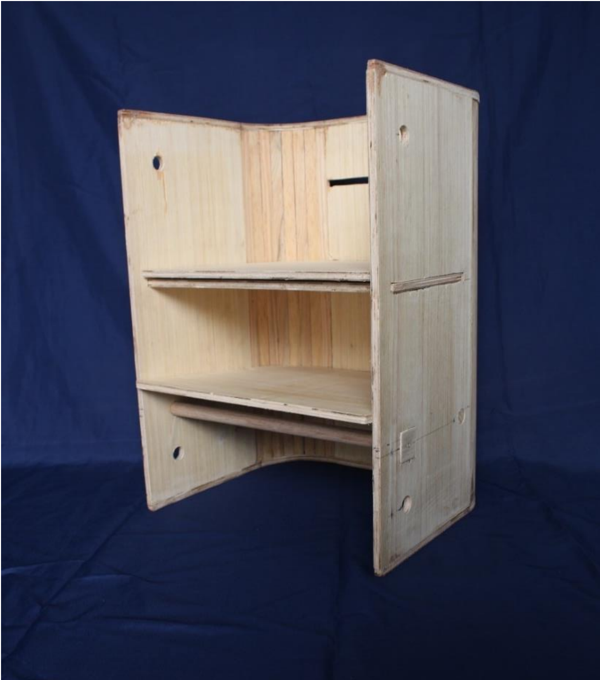
Figura 38. Fotografía de resultado de fabricación del mobiliario en forma de escalera.
