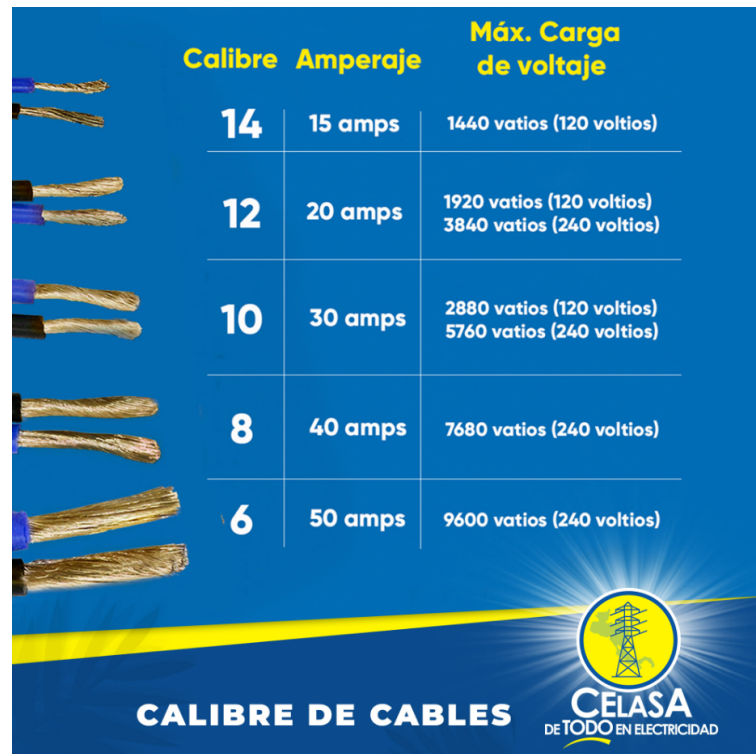
Figura 20: Relación del amperaje y máxima carga de voltaje para calibre del 6 al 14
