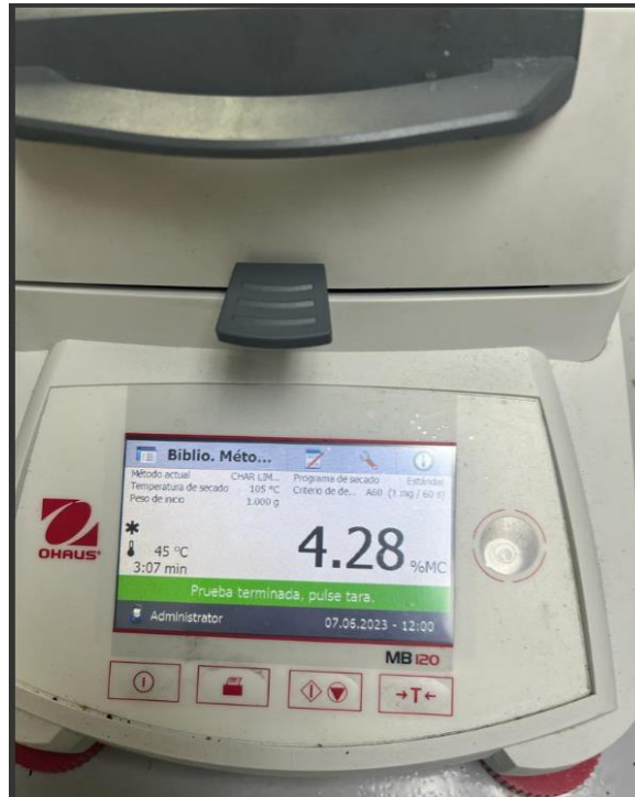
Figura 46. Medición de humedad con balanza de humedad del Laboratorio de Operaciones Unitarias de la Universidad del Valle de Guatemala.
