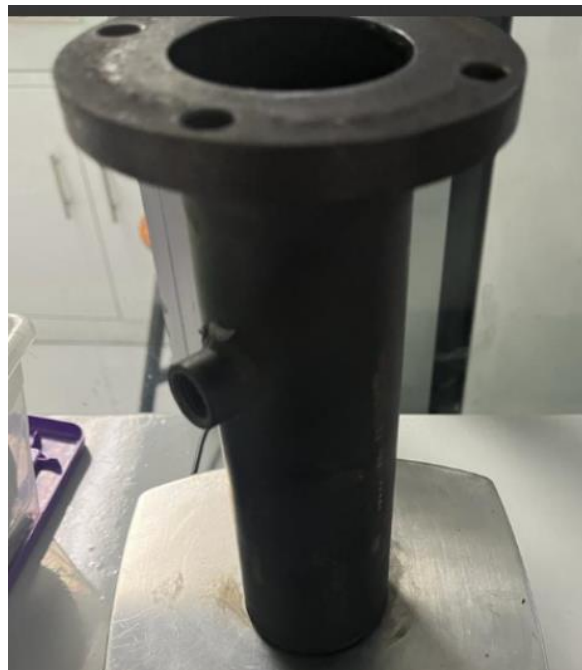
Figura 39. Reactor de pirólisis a escala laboratorio de Laboratorio de Operaciones Unitarias de la Universidad del Valle de Guatemala.
