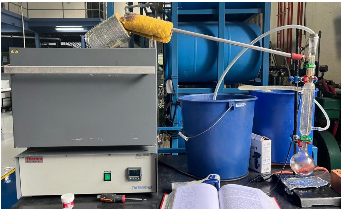
Figura 41. Sistema de pirólisis a escala laboratorio en el Laboratorio de Operaciones Unitarias de la Universidad del Valle de Guatemala.
