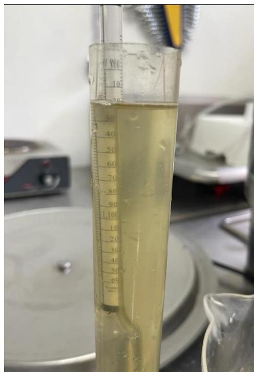
Figura 57. Lectura de gravedad final con hidrómetro lote 2 del método W
