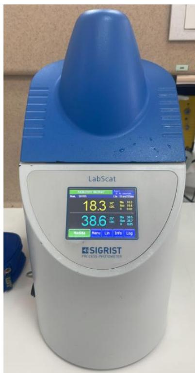
Figura 63. Lectura de IBU en espectrofotómetro
