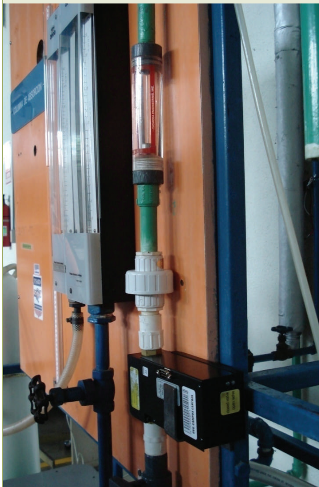
► Figura 5. Válvula para el control del flujo de líquido
