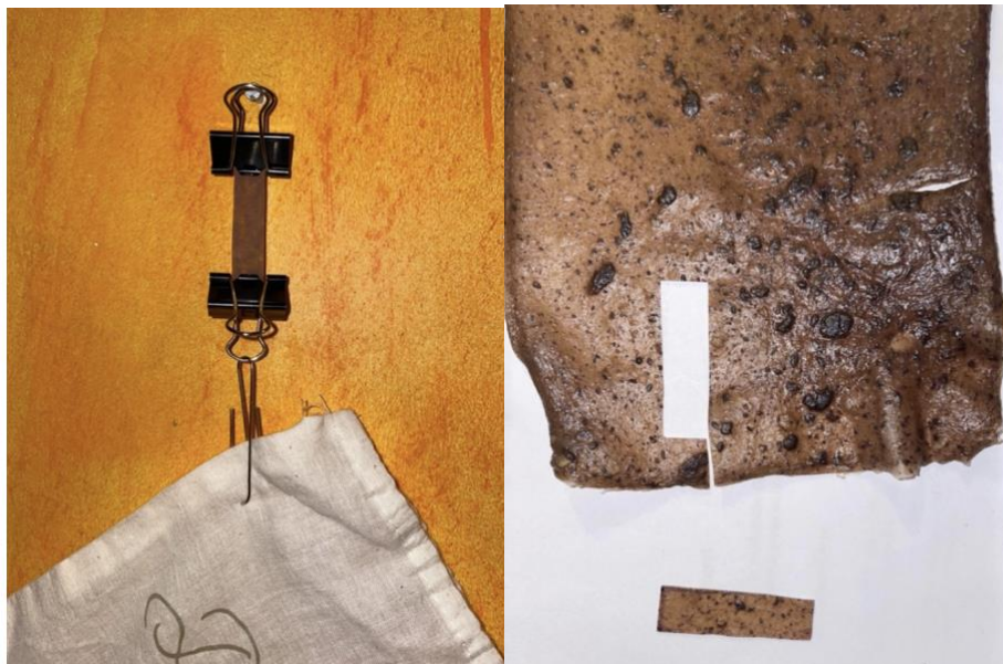
Figura 33. Pruebas de tensión a micelio de P.chrysosporium tratado con agar.
