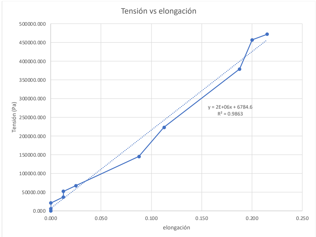
Figura 36. Tensión vs elongación del micelio sometido a pruebas de tensión corrida 2
