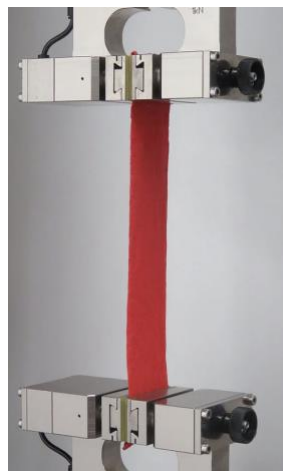
Figura 4. Pruebas de tensión en textiles.
