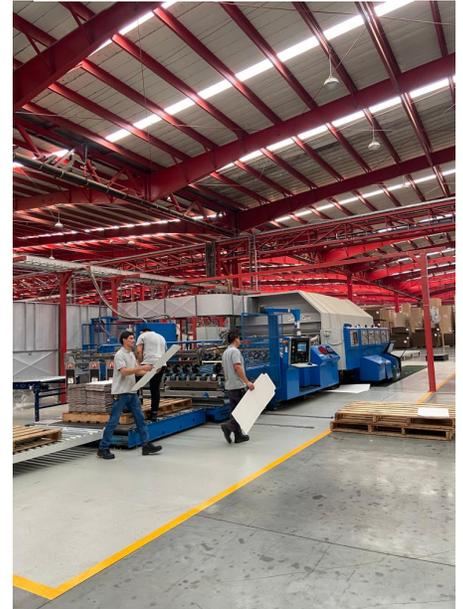
Previo al entregar la máquina ya instalada, se necesitó realizar pruebas de funcionamiento de cada parte y sistema eléctrico. Se realizó este análisis para observar si todas las piezas de la máquina funcionaban y si se instalaron de manera correcta.
