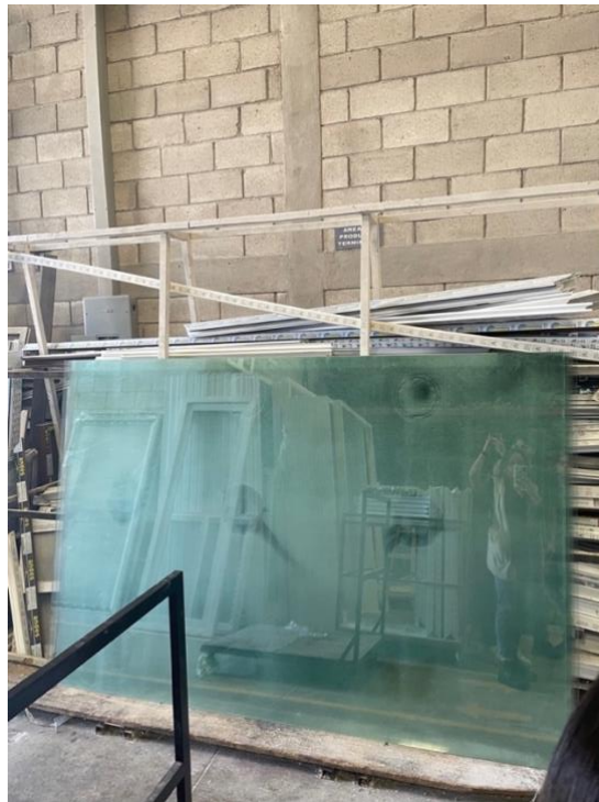
Figura 3. Planchas de vidrio mal almacenadas en área de carga y descarga
