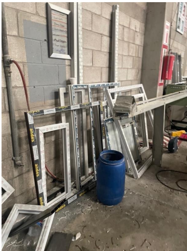
Figura 5. Inventario (WIP) obstruyendo extintor
