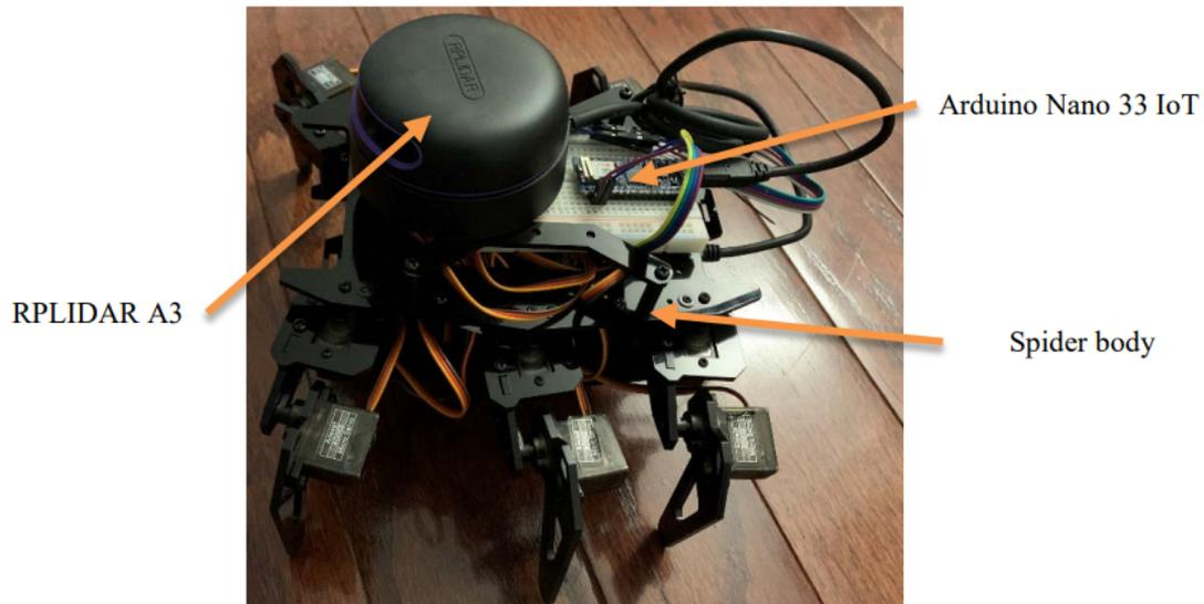
Figura 2: Prototipo final de la araña robótica.
