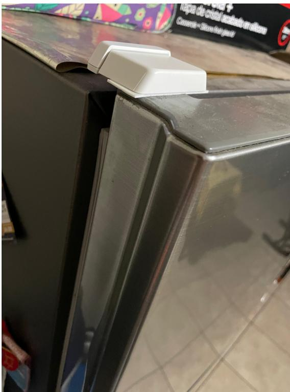
Figura 21: Sensor de temperatura y de apertura Zigbee integrado con Platypush.
