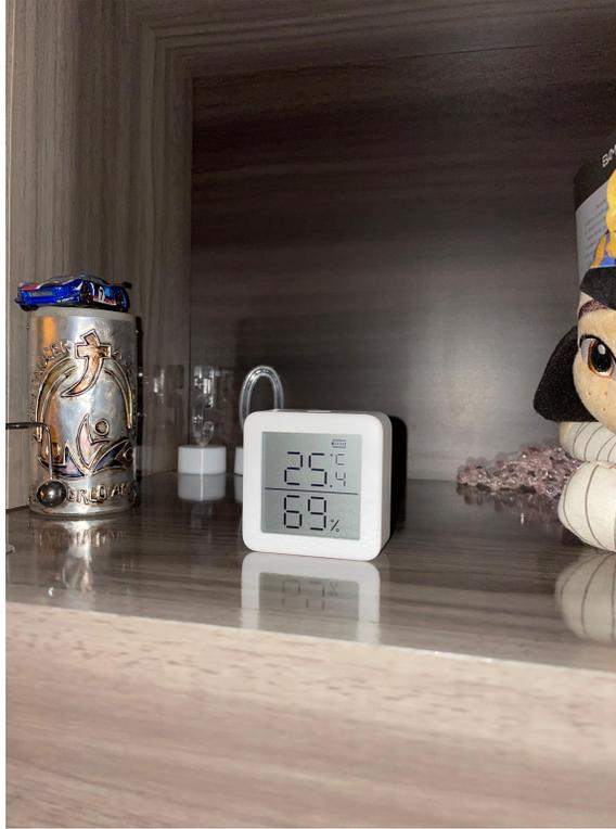
Figura 23: Sensor Bluetooth de temperatura y humedad utilizado.
