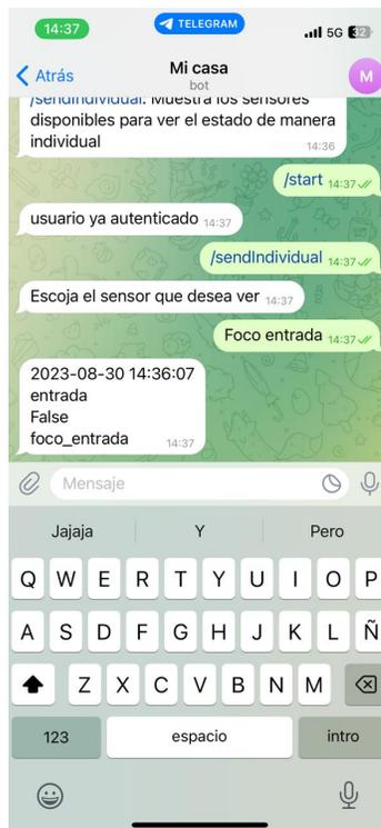
Figura 30: Respuesta del Bot al estado de un sensor.
