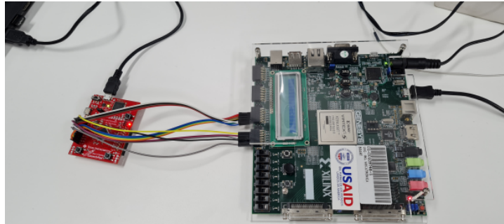
Figura 6: Circuito implementado en FPGA para comprobar que las salidas sean las esperadas
