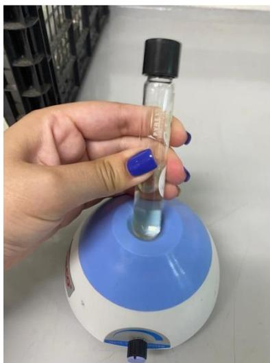
La figura anterior muestra la agitación, utilizando un Vortex, de la manteca de cacao esterificada para poder ser analizada por el cromatógrafo de gas.
