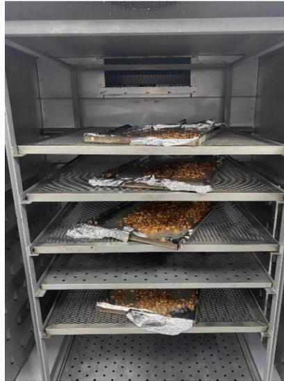
En la figura anterior se muestra el proceso de secado de los granos de cacao. El proceso de secado se realizó en un secador de bandejas durante 4 horas a 80°C para asegurarnos que se elimine la humedad por lo menos al 50%.
