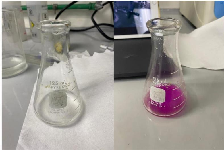
La figura anterior muestra la solución ácida con Manteca de cacao y fenolftaleína para determinar el volumen de KOH utilizado para titular y determinar el valor de saponificación de la manteca.
