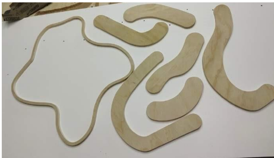
Figura 50. Corte de piezas CNC elementos táctiles
