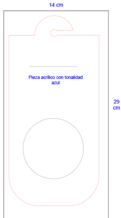
Ilustración 28. Área utilizada para fabricación de acrílico transparente con tonalidad azul
