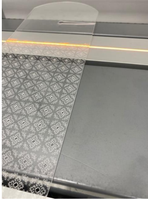
Ilustración 23. Proceso de fabricación, dobléz de acrílico
