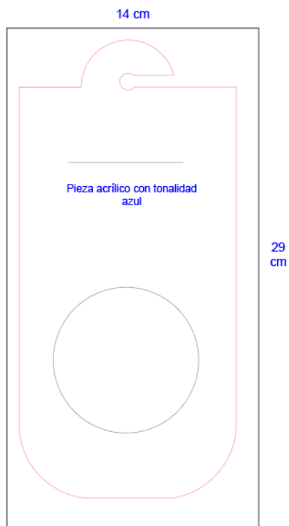
Ilustración 49. Área utilizada para fabricación de acrílico transparente con tonalidad azul
