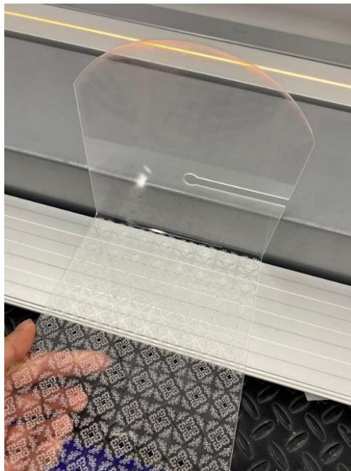
Ilustración 24. Aplicación de dobléz de acrílico a 90°
