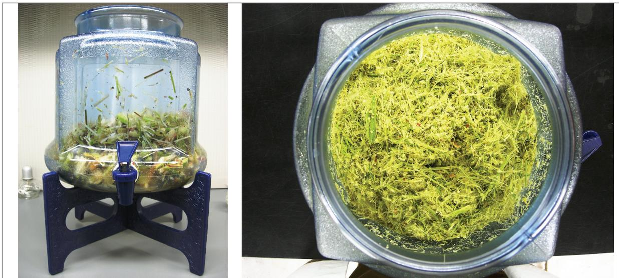
**Gráfica 4.** Fermentación al estado sólido de trozos prensados de sorgo dulce, vista lateral y superior del recipiente utilizado
