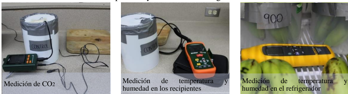
Figura 8. Medición de la producción de \text{CO}_2 , temperatura y humedad de los recipientes y temperatura y humedad del refrigerador.
