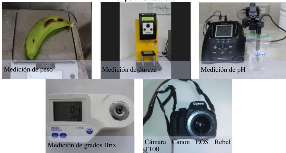
Figura 10. Medición de peso, dureza, pH, grados Brix y cámara utilizada durante la experimentación.
