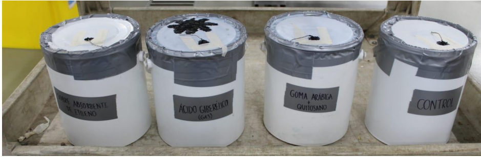
Figura 9. Recipientes utilizados para la medición de la tasa de respiración del banano Gros Michel aplicando diferentes tratamientos.
