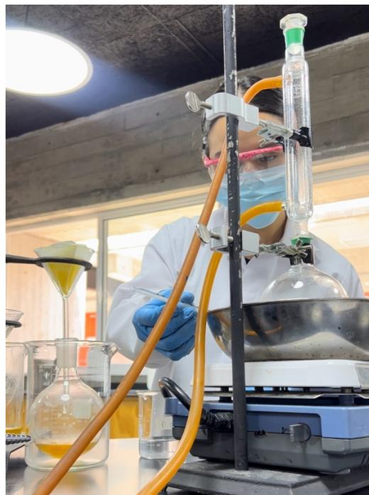
**Anexo No. 14.** Filtrado de extractos por gravedad (etanólico y acetato de etilo) y vacío (acuoso).
