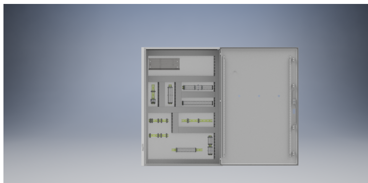
Figura 13: Modelo 3D de la estructura del tablero
