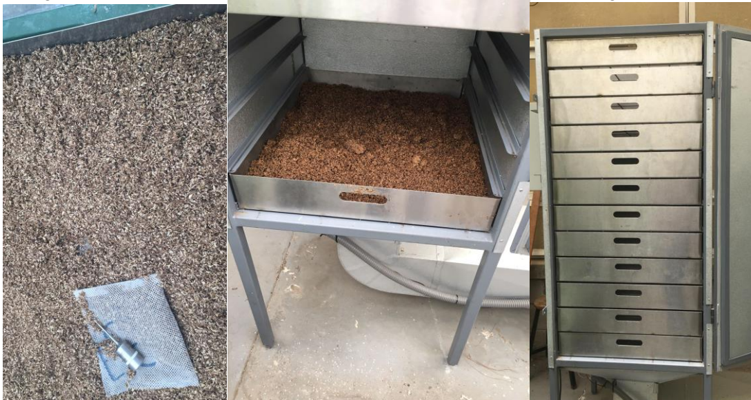
Figura 27 Deshidratación del bagazo de cerveza en el deshidratador de gabinete en la UVG.
