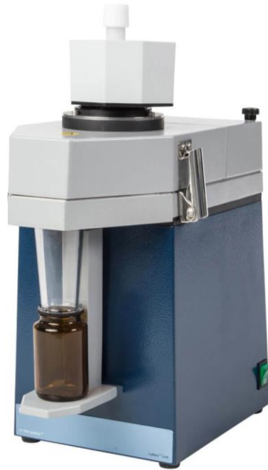
Figura 28 Molino y ciclón marca FOSS clyclotec TM 1093, ubicado en el laboratorio de química de alimentos de la UVG.
