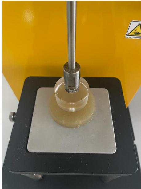
Figura 22: Posición de hidrogel para pruebas mecánicas
