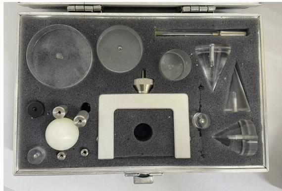
Figura 39: Tipos de cabezales de texturómetro
