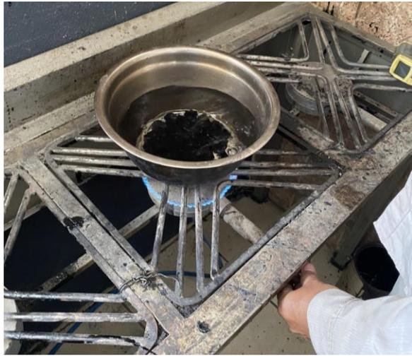
**Figura 32.** Mezcla asfáltica con asfalto AC30 colocado sobre una superficie blanca tras la prueba de hervido realizada en el laboratorio de la empresa Serpin
