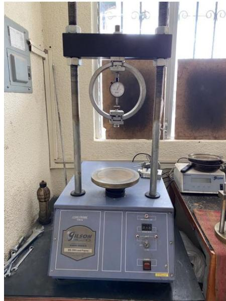
**Figura 29.** Mordaza de Lottman utilizado para el ensayo TSR en el laboratorio de la empresa Serpin
