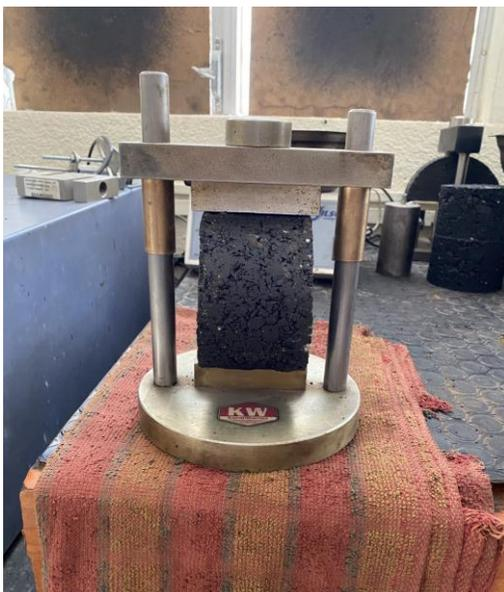
**Figura 30.** Agregado pétreo pintado con asfalto AC30 para prueba de hervido realizada en el laboratorio de la empresa Serpin
