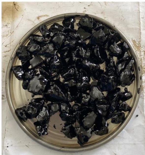
**Figura 31.** Mezcla asfáltica con asfalto AC30 durante la prueba de hervido sobre una estufa de gas del laboratorio de la empresa Serpin
