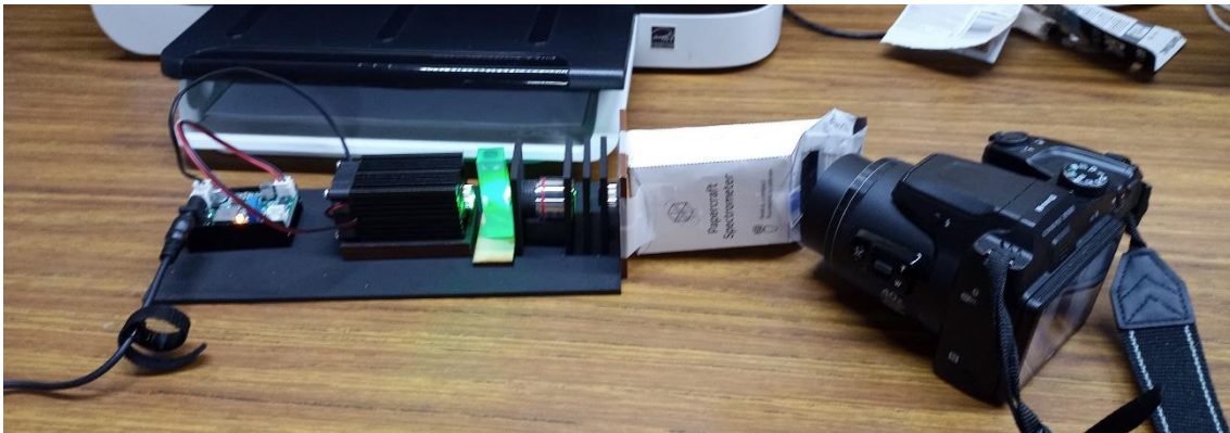
Figura #19: Prototipo 2.2 con una muestra de acetona
