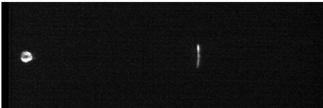
Figura #14: Imagen de un espectro Raman sin muestra generada por el prototipo 2
