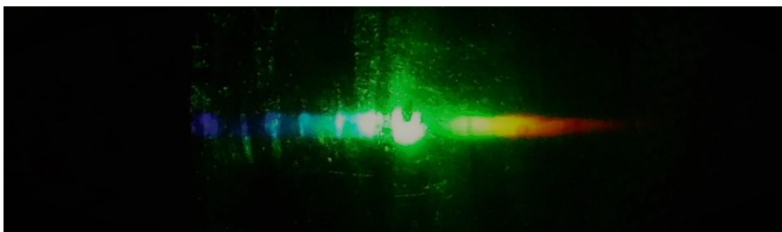
Figura #10: Imagen de un espectro Raman de peróxido de hidrógeno obtenido experimentalmente con el prototipo 2.1
