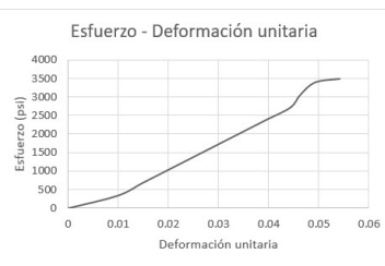
Figura 43: Ensayo de tensión de cachaza de caña, Esfuerzo - deformación unitaria probeta No. 3
