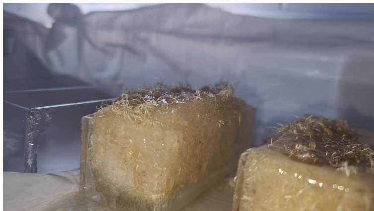
Figura 28: Reacción exotérmica de la luffa
