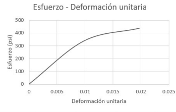
Figura 60: Ensayo de tensión de cachaza de caña, Esfuerzo - deformación unitaria probeta No. 5
