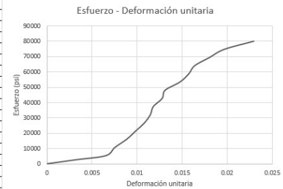
Figura 94: Ensayo de flexión de fibra de coco, Esfuerzo - deformación unitaria probeta No. 4
