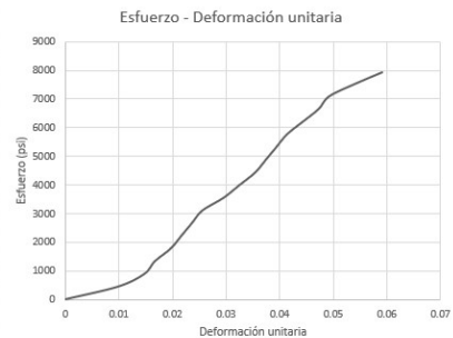
Figura 75: Ensayo de compresión de cachaza de caña, Esfuerzo - deformación unitaria probeta No.
