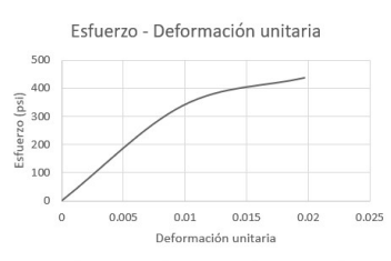
Figura 45: Ensayo de tensión de cachaza de caña, Esfuerzo - deformación unitaria probeta No. 5
