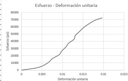
Figura 95: Ensayo de flexión de fibra de coco, Esfuerzo - deformación unitaria probeta No. 5
