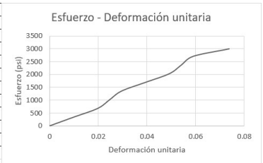
Figura 64: Ensayo de tensión de fibra de coco, Esfuerzo - deformación unitaria probeta No. 4
