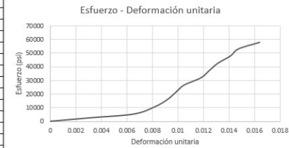
Figura 93: Ensayo de flexión de fibra de coco, Esfuerzo - deformación unitaria probeta No. 3
