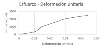
Figura 59: Ensayo de tensión de cachaza de caña, Esfuerzo - deformación unitaria probeta No. 4
