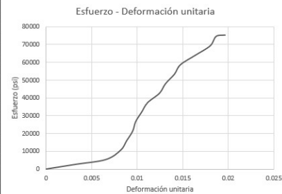
Figura 89: Ensayo de flexión de cachaza de caña, Esfuerzo - deformación unitaria probeta No. 4
