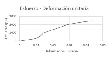
Figura 44: Ensayo de tensión de cachaza de caña, Esfuerzo - deformación unitaria probeta No. 4
