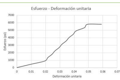
Figura 80: Ensayo de compresión de fibra de coco, Esfuerzo - deformación unitaria probeta No. 5
