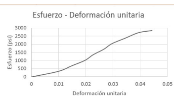
Figura 42: Ensayo de tensión de cachaza de caña, Esfuerzo - deformación unitaria probeta No. 2
