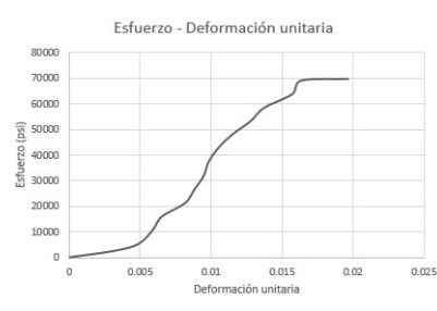
Figura 81: Ensayo de flexión de luffa, Esfuerzo - deformación unitaria probeta No. 1
