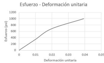
Figura 61: Ensayo de tensión de fibra de coco, Esfuerzo - deformación unitaria probeta No. 1
