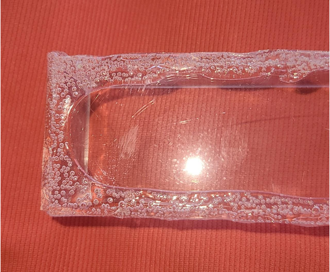
Figura 25: Aplicación de silicona fría
