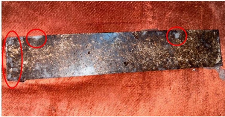
Figura 18: Probetas defectuosas por humedad en la fibra
