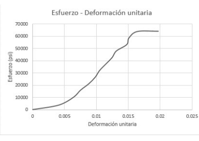
Figura 82: Ensayo de flexión de luffa, Esfuerzo - deformación unitaria probeta No. 2
