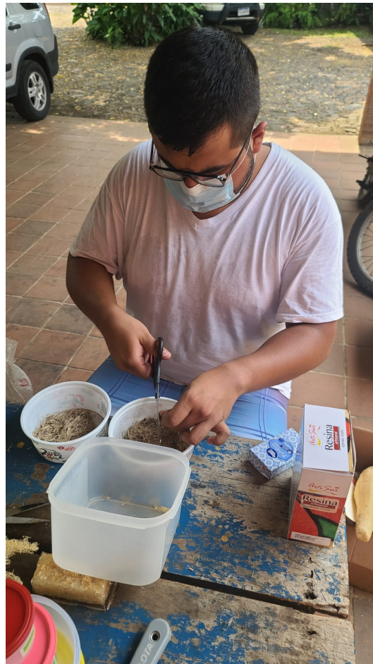
Figura 20: Corte de las fibras con longitudes superiores a 0.75 pulgadas
