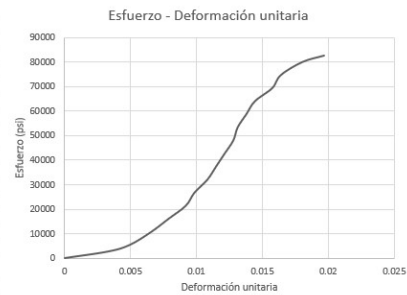
Figura 90: Ensayo de flexión de cachaza de caña, Esfuerzo - deformación unitaria probeta No. 5
