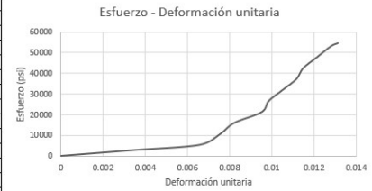
Figura 92: Ensayo de flexión de fibra de coco, Esfuerzo - deformación unitaria probeta No. 2
