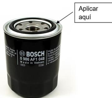
8. Instalar el filtro nuevo a mano, apretarlo lo suficiente para que no existan fugas, pero no forzar el ajuste del filtro.
