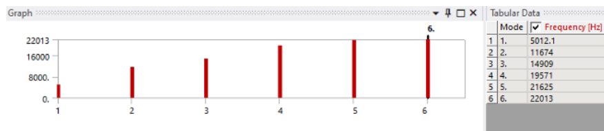
Figura 35: Frecuencias naturales estructura soporte
