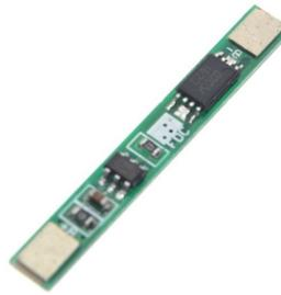
Figura 26: BMS para una celda con salida de hasta 3 A [25].
