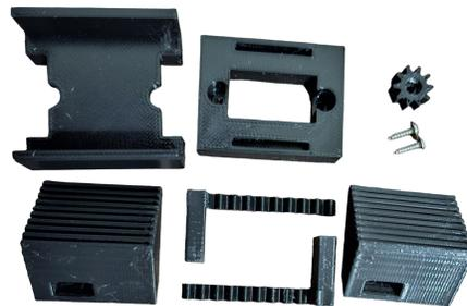
Figura 27: Piezas para ensamblar el efector final.
