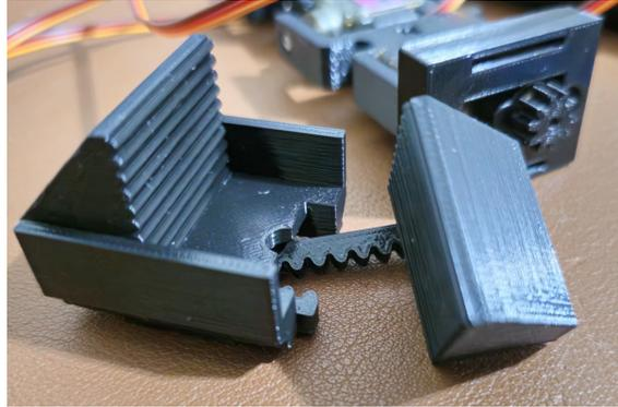
Figura 40: Montando las garras en la parte superior.
