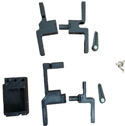
Figura 24: Piezas para ensamblar los eslabones del manipulador serial.
