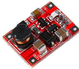
Figura 27: Módulo elevador de voltaje a 5V.
