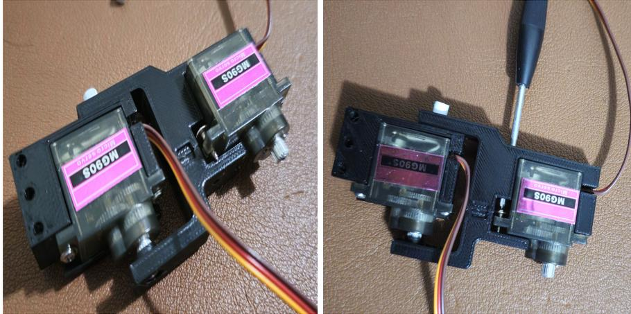
Figura 34: Cómo insertar el segundo servomotor.
