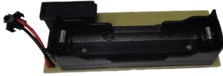
Figura 37: Placa de la celda manufacturada y montada
