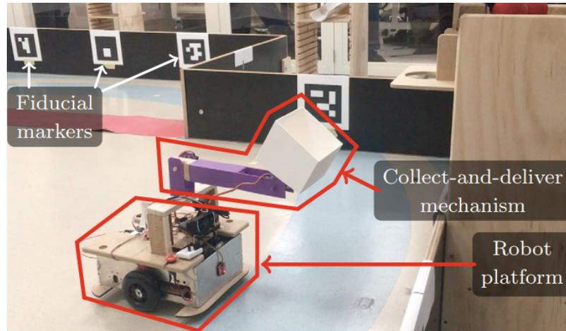
Figura 2: Plataforma robótica implementada en la Universidad de Melbourne [4].
