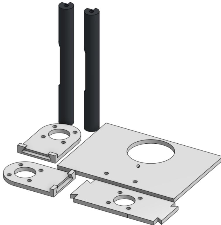
Figura 112: Ejemplo de orientación en la que se imprimieron las partes del torso versión 02
