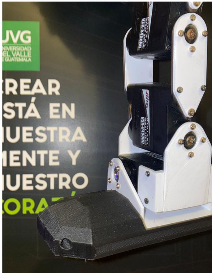
Figura 80: Pieza zapato agregada al ensamblaje de la pierna
