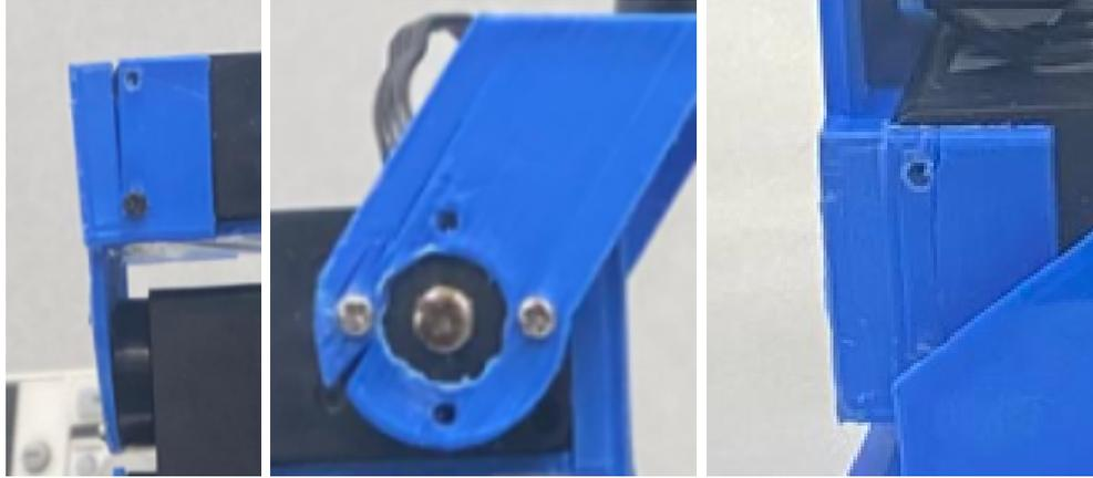
Figura 56: Fallas en construcción de pierna versión 01 en cadera, cintura y tobillo respectivamente
