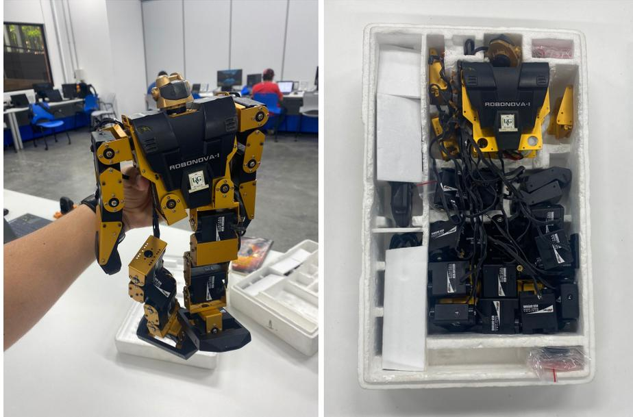
Figura 5: Activo Robonova-1 en malas condiciones, desarmado para desarrollar el presente proyecto
