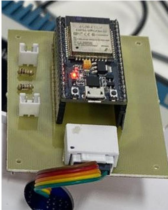
Figura 167: PCB del ESP32 del circuito versión 03
