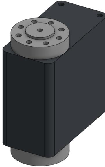
Figura 31: Modelado servomotor Hitec HSR-8498HB tipo 2
