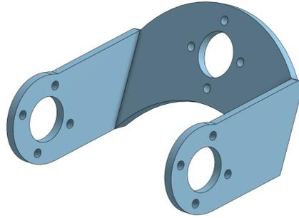
Figura 54: Orientación en la que se imprimió la cintura versión 01
