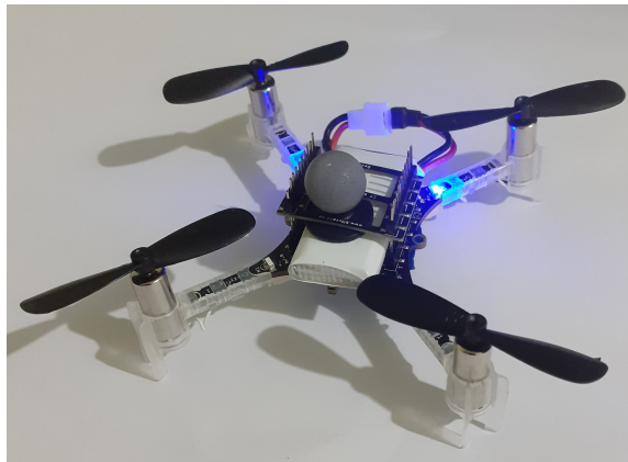
Figura 62: Crazyflie 2.1 con marcador reflectivo integrado
