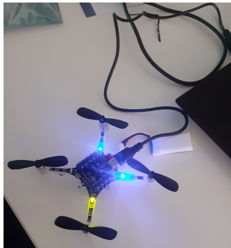
Figura 42: Conexión de Crazyflie 2.1 mediante cable para actualización de firmware
