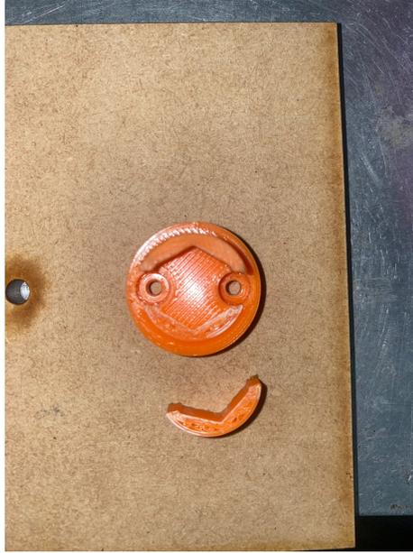
Figura 70: Delaminación acople de ensayo
