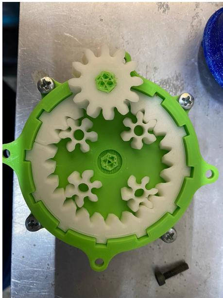
Figura 72: Delaminación planet carrier segunda etapa
