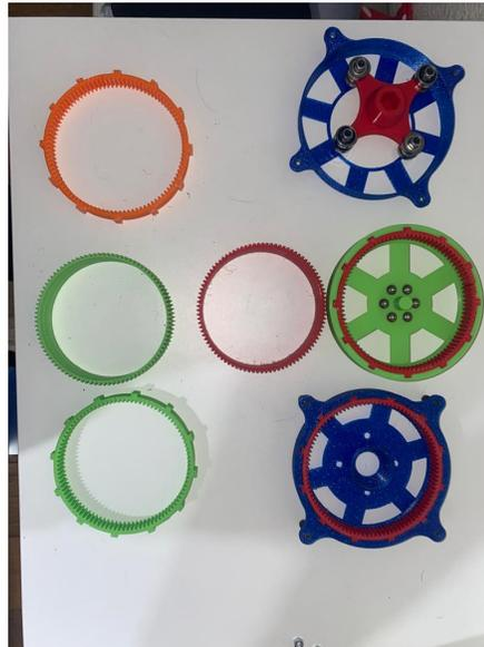
Figura 46: Partes de caja armónica en PLA y PETG
