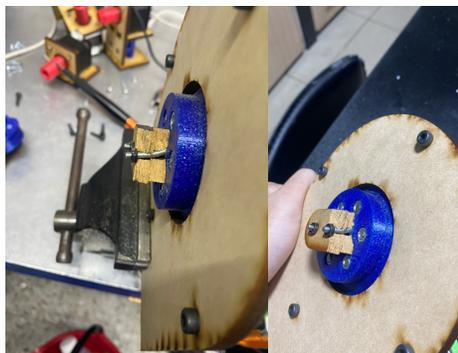
Figura 76: Rotura brazo de 30 cm
