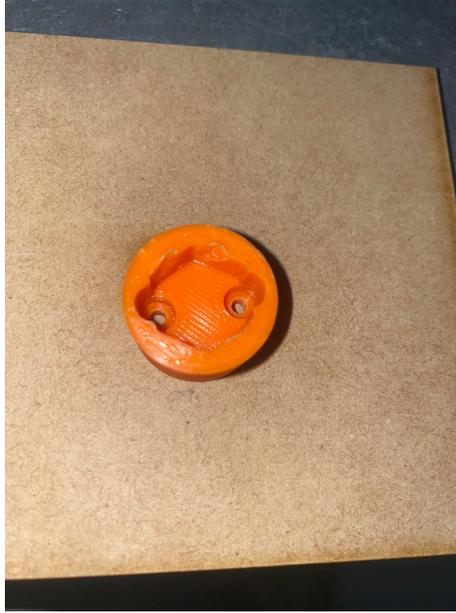
Figura 74: Deformación acople caja grande
