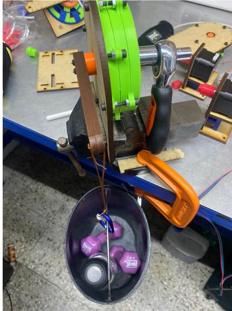
Figura 73: Ensayo de caja planetaria grande
