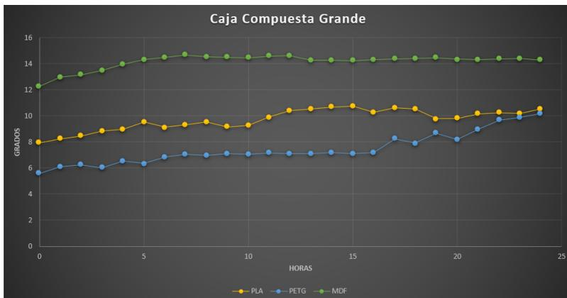
Figura 81: Gráfica caja grande ensayo de fatiga
