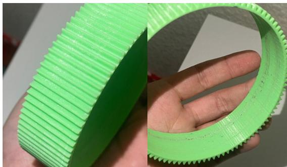
Figura 90: Anillo flexible después de ensayo de fatiga
