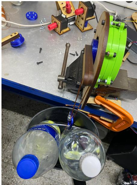
Figura 75: Acople nuevo para transmisión de salida caja grande
