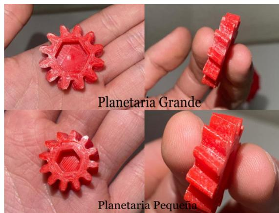
Figura 87: Planetarias con fatiga
