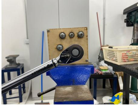
Figura 52: Ensayo de torsión.
