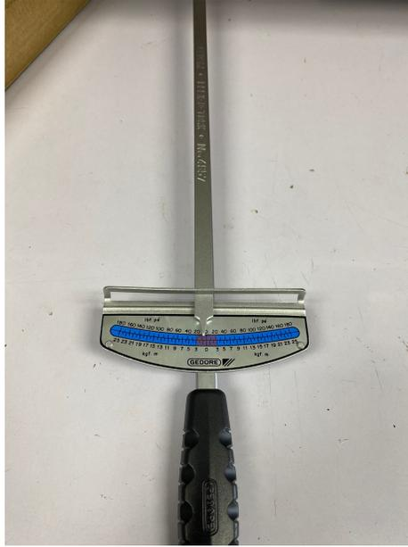
Figura 50: Torquímetro de aguja.
