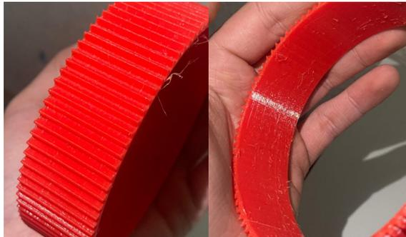
Figura 89: Anillo flexible antes de ensayo de fatiga
