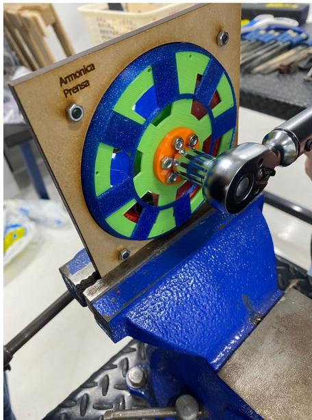
Figura 61: Configuración de ensayo para caja armónica
