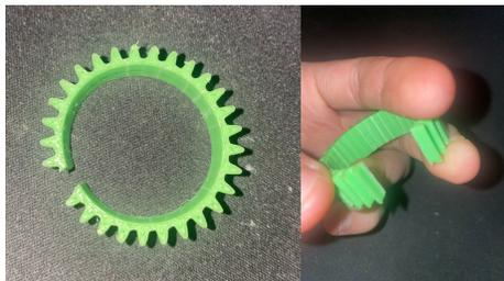
Figura 64: Fallo en acople de prueba de torsión
