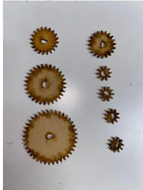
Figura 38: Engranes fabricados en MDF.
