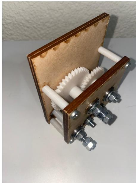
Figura 39: Caja compuesta ensamblada
