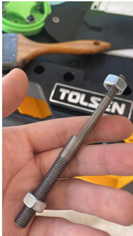
Figura 55: Eje maquinado
