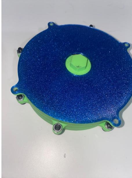
Figura 44: Cajas planetarias ensamblada
