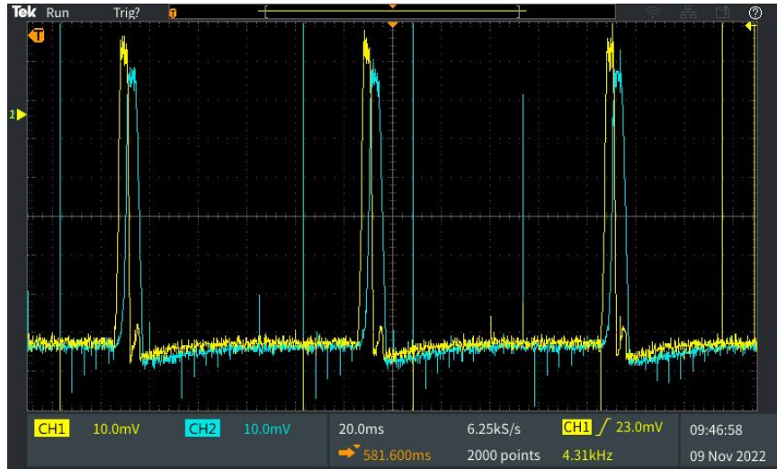
Figura 35: Potencial de acción de un axón conformado por dos unidades neuronales de Hoshimiya utilizando el generador de -12V. Duty Cycle = 10%.
