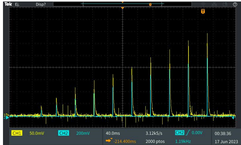
Figura 53: Respuesta de la membrana de una unidad de Hoshimiya a pulsos con amplitud entre 100 y 900 mV en intervalos de 100 mV, con f = 20 \text{ Hz} y t_{pulsos} = 0.5 \text{ ms} .
