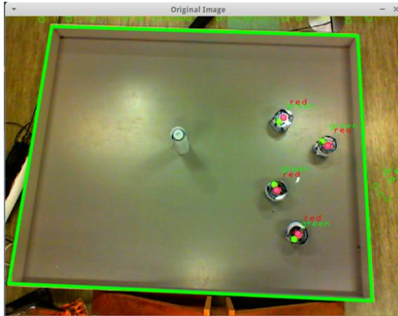
Figura 2: Robots ChIRP examinados mediante el software de captura [5]
