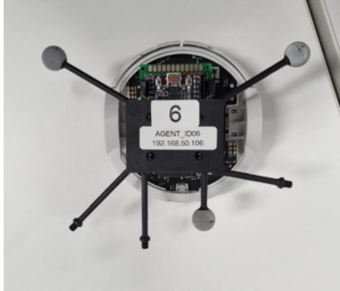
Figura 20: Marcador acoplado al robot móvil con ruedas Pololu 3pi+
