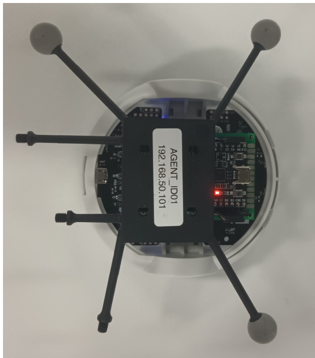
Figura 23: Pololu 3pi+ con un marcador del sistema de cámaras Optitrack.
