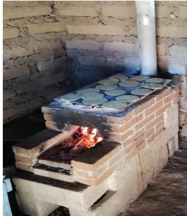
Figura 1. Estufa eficiente Chapina Bonita construida en Aguacatán y en uso. Información y video disponibles en https://chapinabonita.com/
