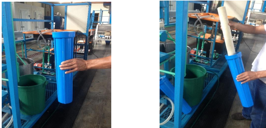
Ilustración 15. Colocación de las membranas en la carcasa.
