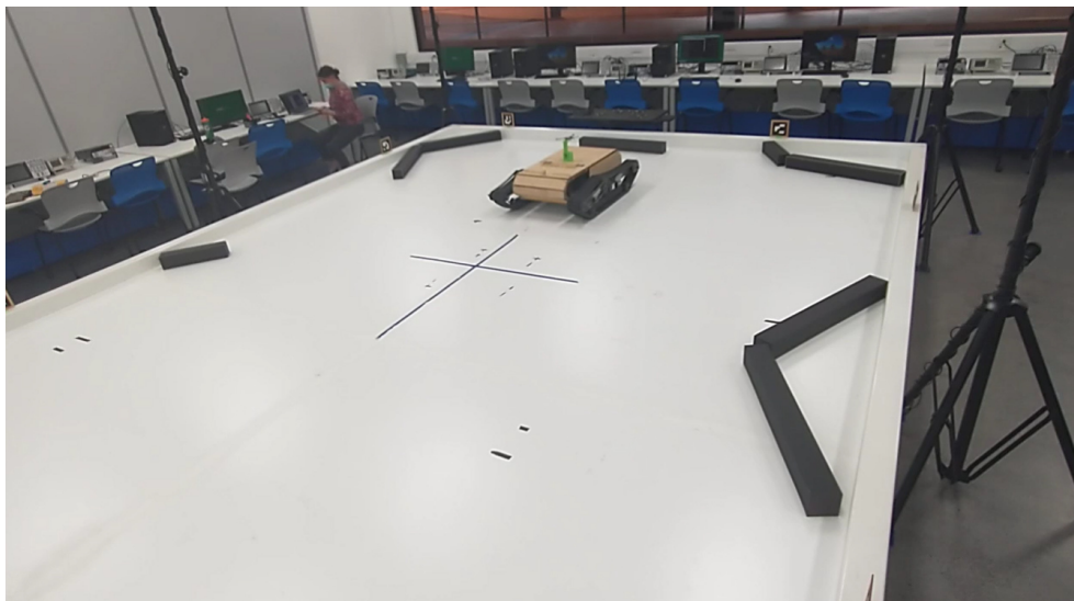
Figura 51: Rover UVG realizando SLAM dentro de la plataforma Robotat
