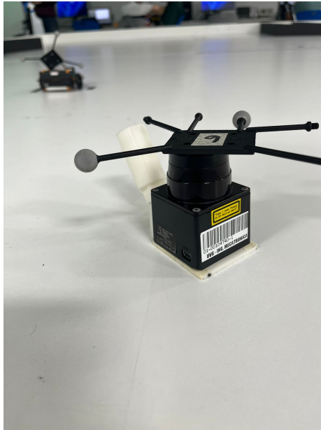
Figura 36: Montaje de Sensor Lidar Hokuyo y marker de Optitrack para realizar SLAM físico
