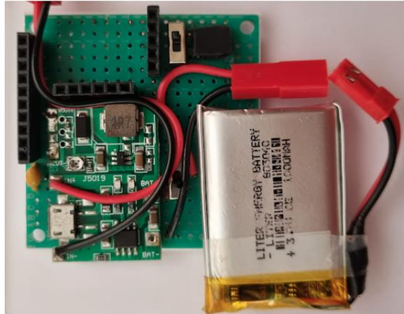
Figura 13: Placa de potencia finalizada
