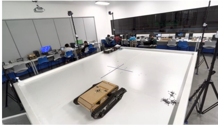
Figura 30: Rover UVG sobre la plataforma para pruebas de control punto a punto.
