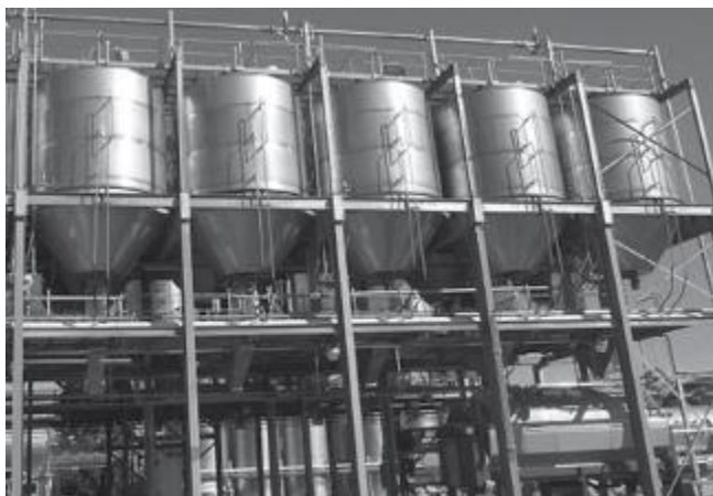
Figura 5. Fermentador estático cerrado.
