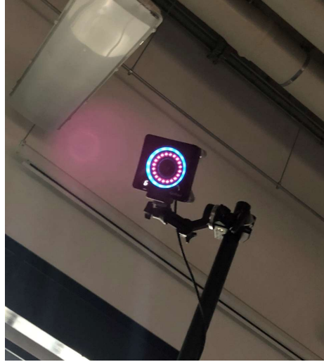
Figura 11: Cámara Prime x 41 del sistema OptiTrack en UVG.
