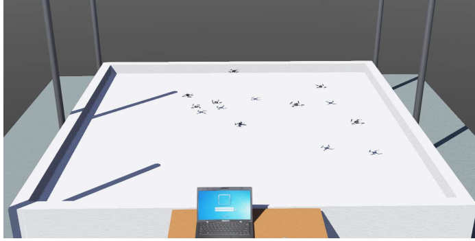
Figura 46: Formación fallida para 8 Crazyflies 2.0 , error disminución de velocidad máxima.
