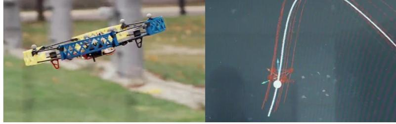
Figura 10: Un dron en un Sistema de captura de movimiento óptico pasivo [21].
