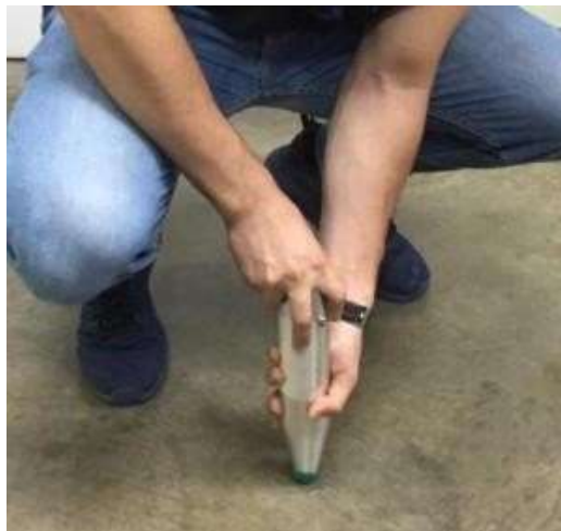
Figura 64: Ejemplo de ensayo con martillo de rebote (Morales, 2019)
