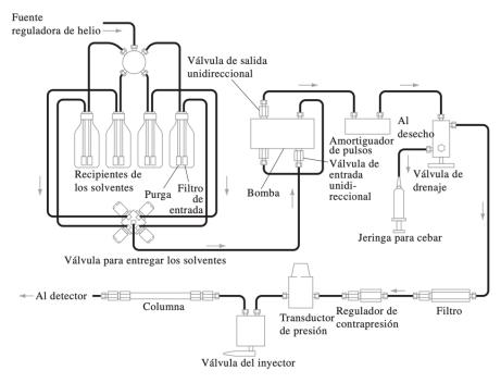
**Figura No. 12.** Diagrama del equipo de un cromatógrafo HPLC (Skoog et al., 2015).
