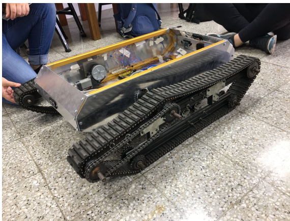
Figura 2: Robot explorador que servirá como plataforma móvil [3].
