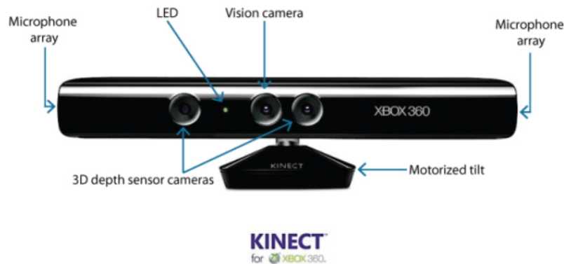
Figura 10: Configuración de módulos dentro del Kinect [1].
