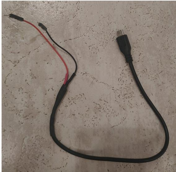
Figura 25: Adaptador usado para la ESP32
