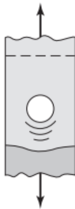
Figura 38: Aplastamiento en elemento y perno Fuente: (Shigley., 2012)
