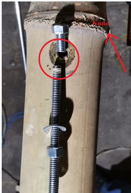
Figura 42: Culmo con nudo, perno falló a 50N \cdot m
