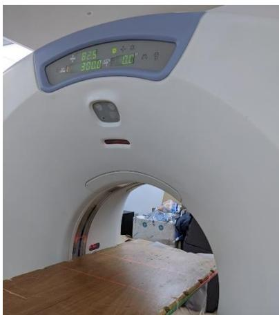
Figura 7.7: TCA01 - desplazamiento de 30 centímetros según indicador del gantry.
