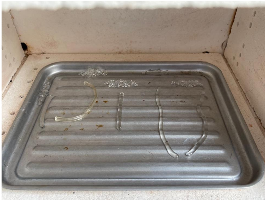
Figura 70. Fotografía de diferentes filamentos a 153 °C
