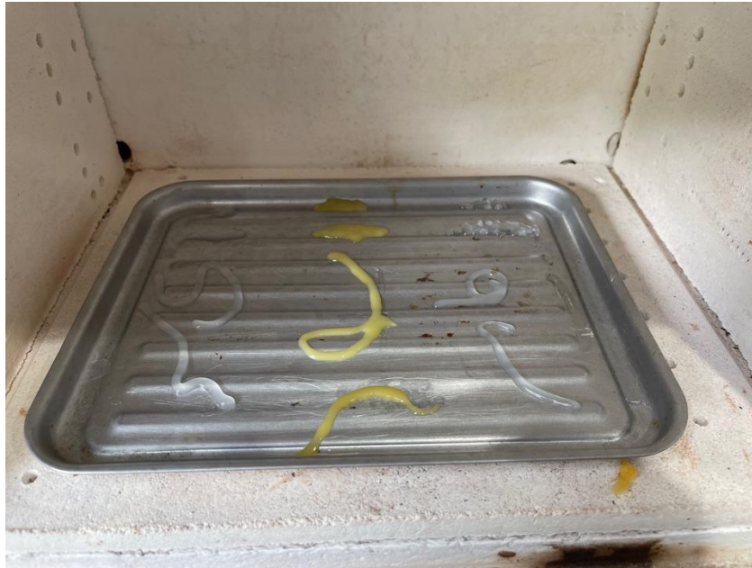
Figura 88. Fotografía de diferentes filamentos a 138 °C
