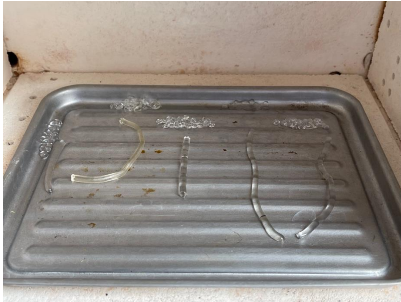
Figura 68. Fotografía de diferentes filamentos a 143 °C
