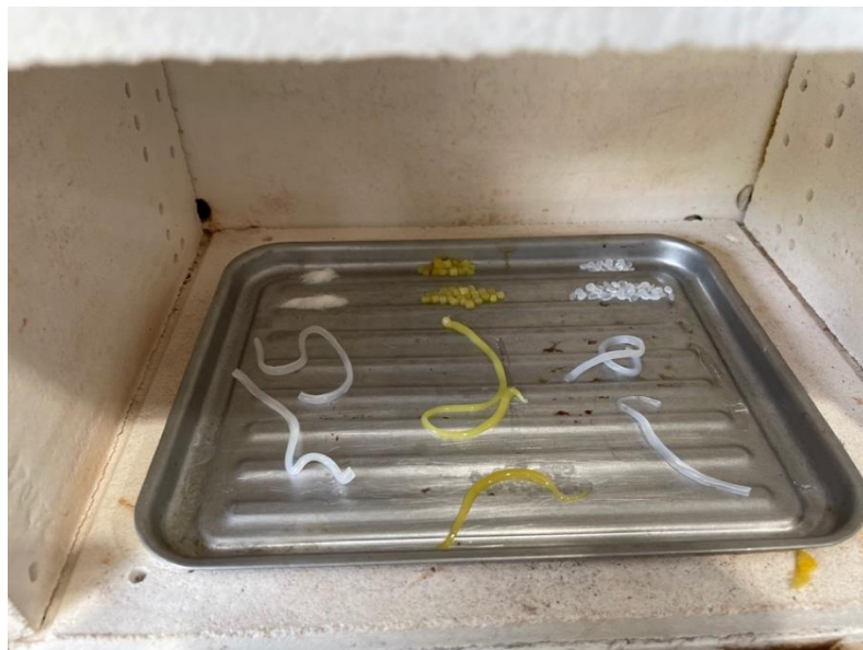
Figura 83. Fotografía de diferentes filamentos a 112 °C
