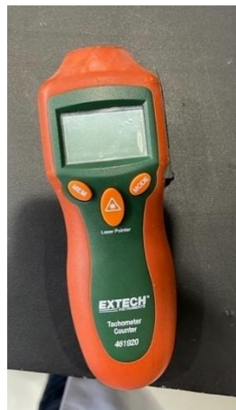
Figura 20. Tacómetro calibrado marca Extech utilizado para calibración de rotor.
