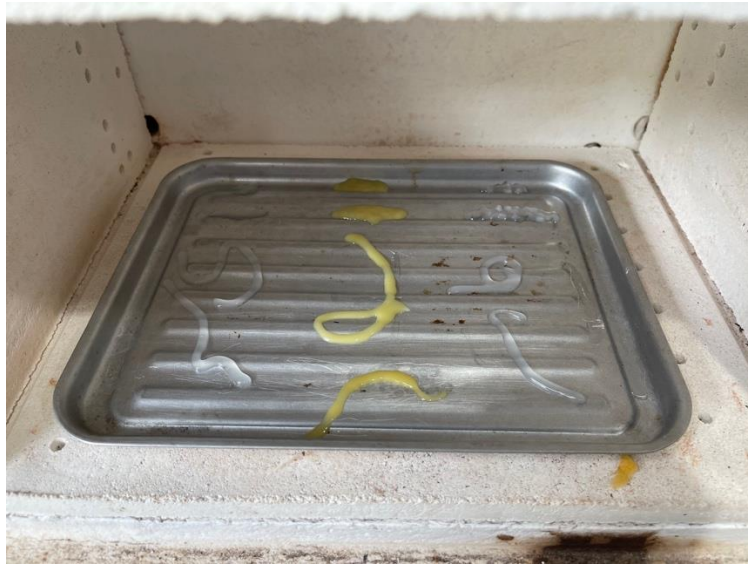
Figura 90. Fotografía de diferentes filamentos a 147 °C
