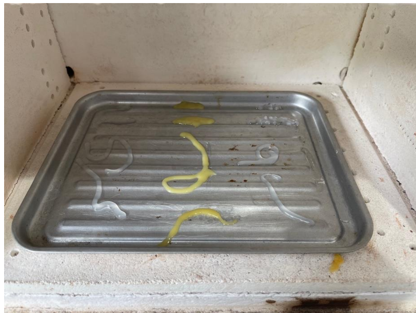
Figura 89. Fotografía de diferentes filamentos a 142 °C
