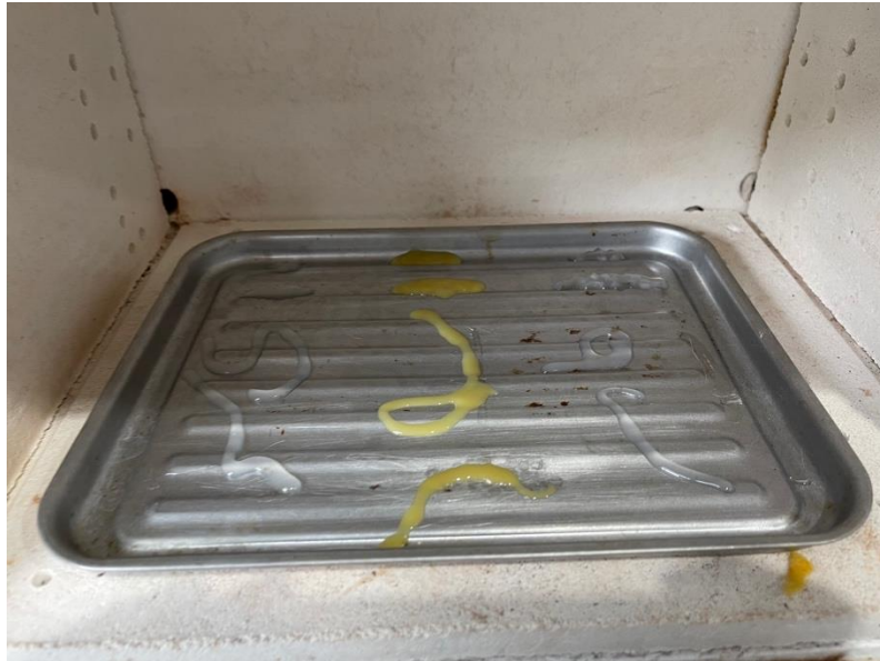
Figura 94. Fotografía de diferentes filamentos a 167 °C
