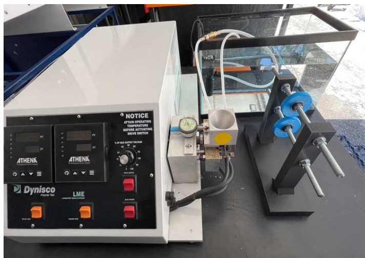
Figura 31. Vista de perfil de implementación de extrusora y sistemas auxiliares instalados en vista de perfil.
