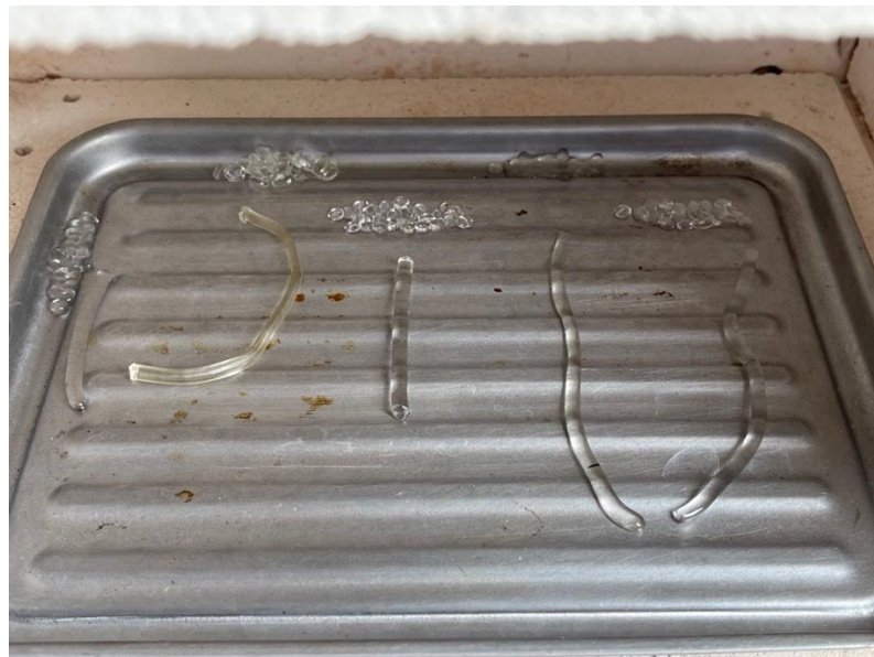
Figura 69. Fotografía de diferentes filamentos a 149 °C
