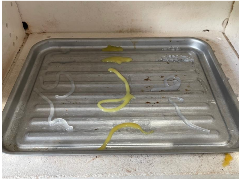
Figura 86. Fotografía de diferentes filamentos a 128 °C
