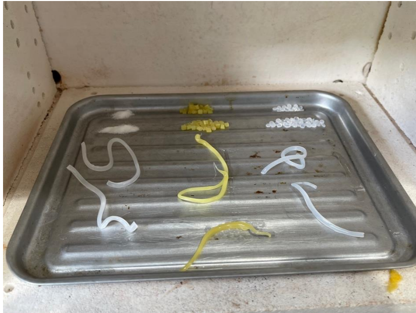
Figura 82. Fotografía de diferentes filamentos a 107 °C
