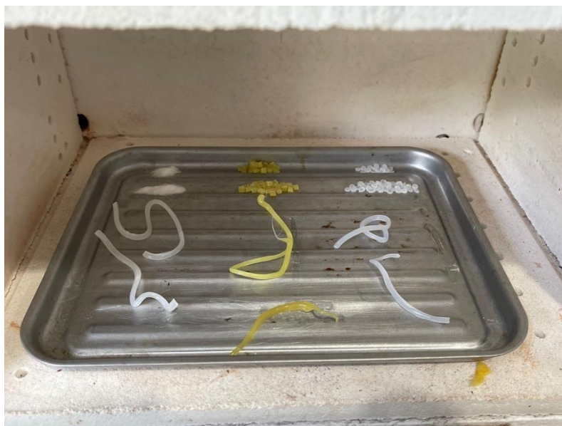
Figura 81. Fotografía de diferentes filamentos a 103 °C
