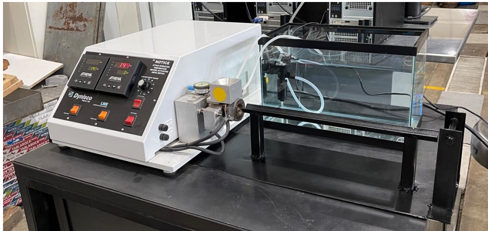
Figura 103. Prototipo de sistema de tracción de filamento.
