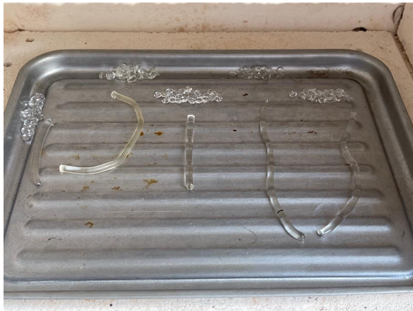
Figura 65. Fotografía de diferentes filamentos a 128 °C
