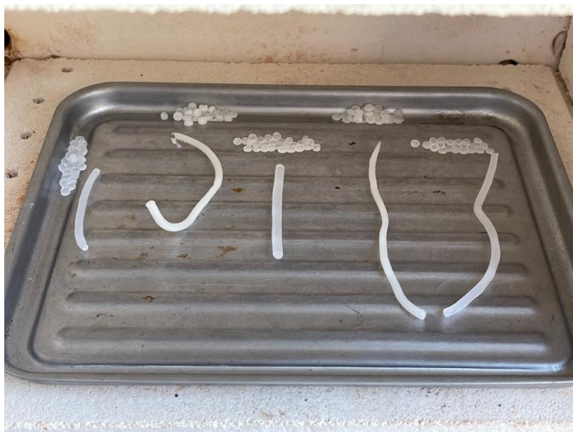
Figura 40. Fotografía de diferentes filamentos a 93 °C
