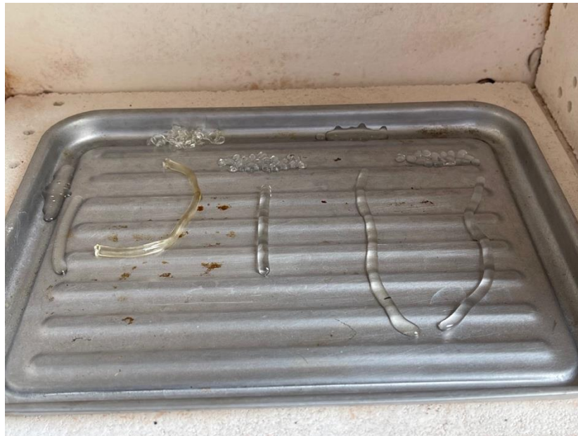
Figura 75. Fotografía de diferentes filamentos a 178 °C
