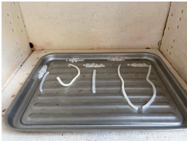
Figura 59. Fotografía de diferentes filamentos a 97 °C.
