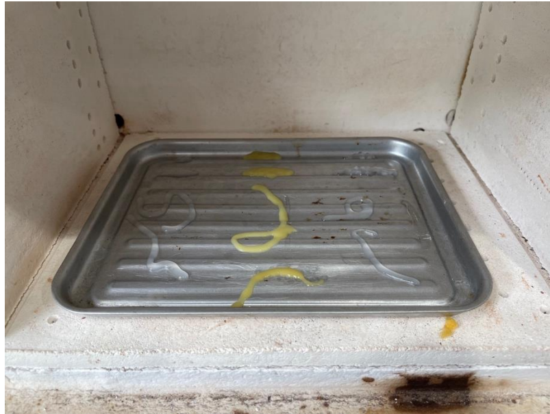
Figura 92. Fotografía de diferentes filamentos a 157 °C
