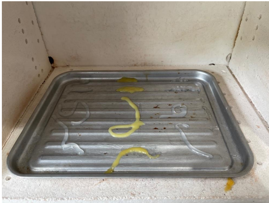
Figura 91. Fotografía de diferentes filamentos a 152 °C
