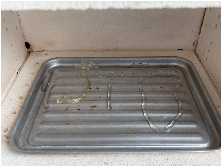
Figura 77. Fotografía de diferentes filamentos a 188 °C
