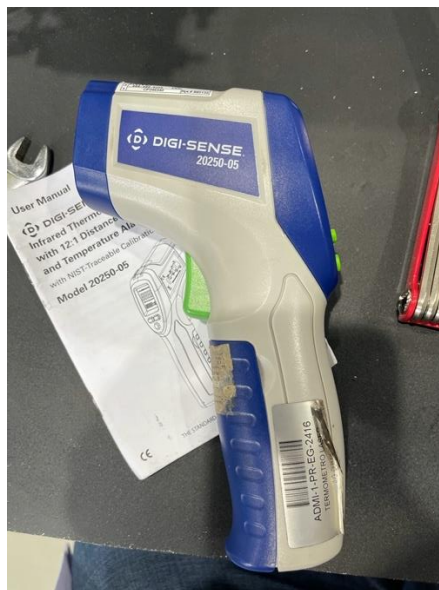
Figura 18. Termómetro infrarrojo marca Digi-Sense utilizado para calibrar sensores y resistencias del rotor y del cabezal.
