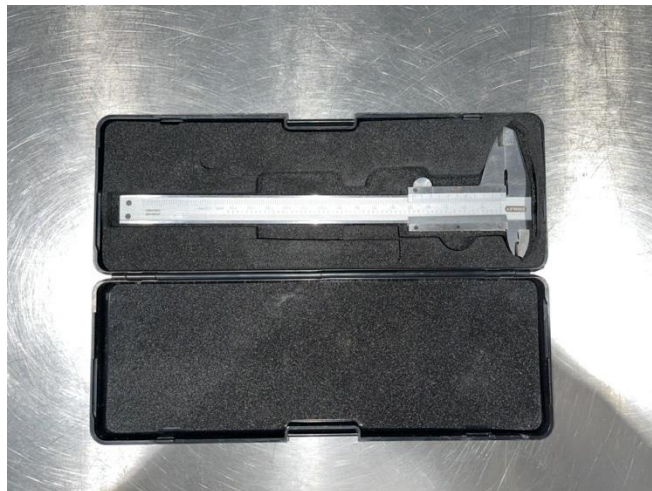
Figura 17. Pie de rey marca Stanley utilizado para calibrar reloj indicador
