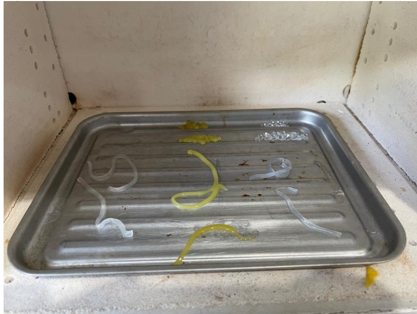
Figura 84. Fotografía de diferentes filamentos a 118 °C
