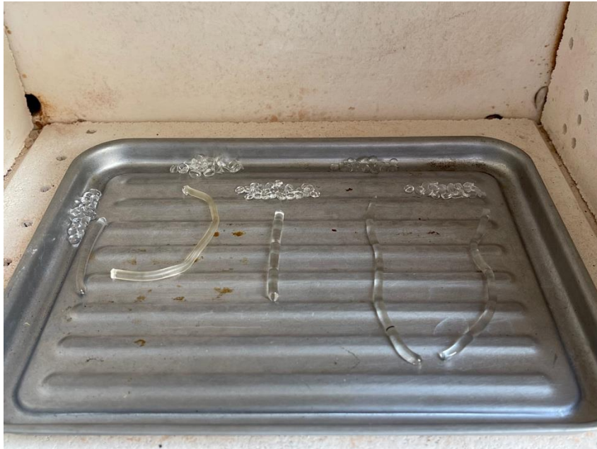
Figura 66. Fotografía de diferentes filamentos a 133 °C.
