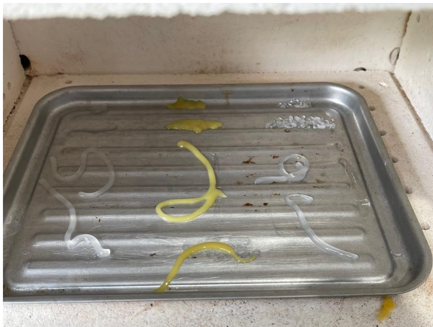
Figura 85. Fotografía de diferentes filamentos a 123 °C
