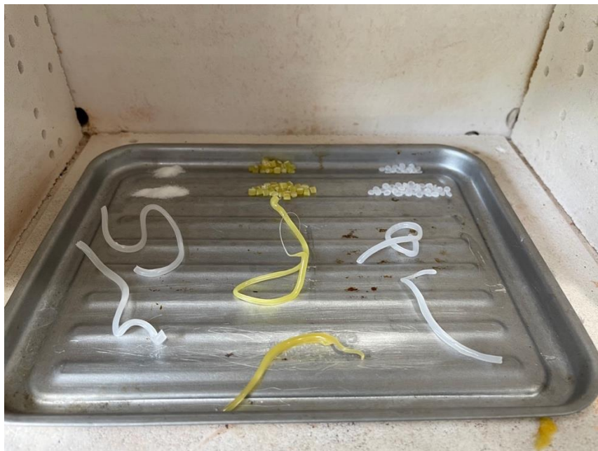
Figura 79. Fotografía de diferentes filamentos a 95 °C
