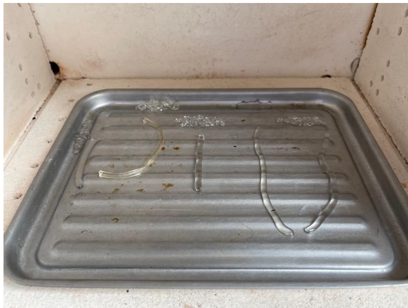
Figura 71. Fotografía de diferentes filamentos a 158 °C
