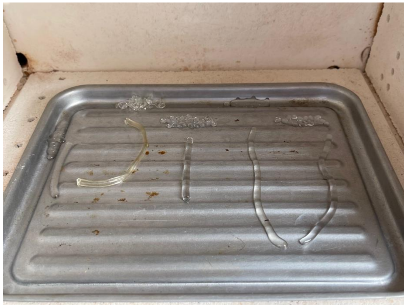
Figura 73. Fotografía de diferentes filamentos a 167 °C
