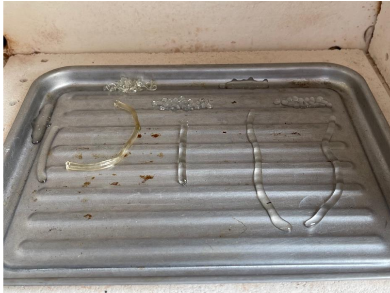
Figura 76. Fotografía de diferentes filamentos a 182 °C
