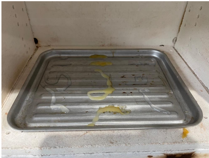
Figura 99. Fotografía de diferentes filamentos a 192 °C
