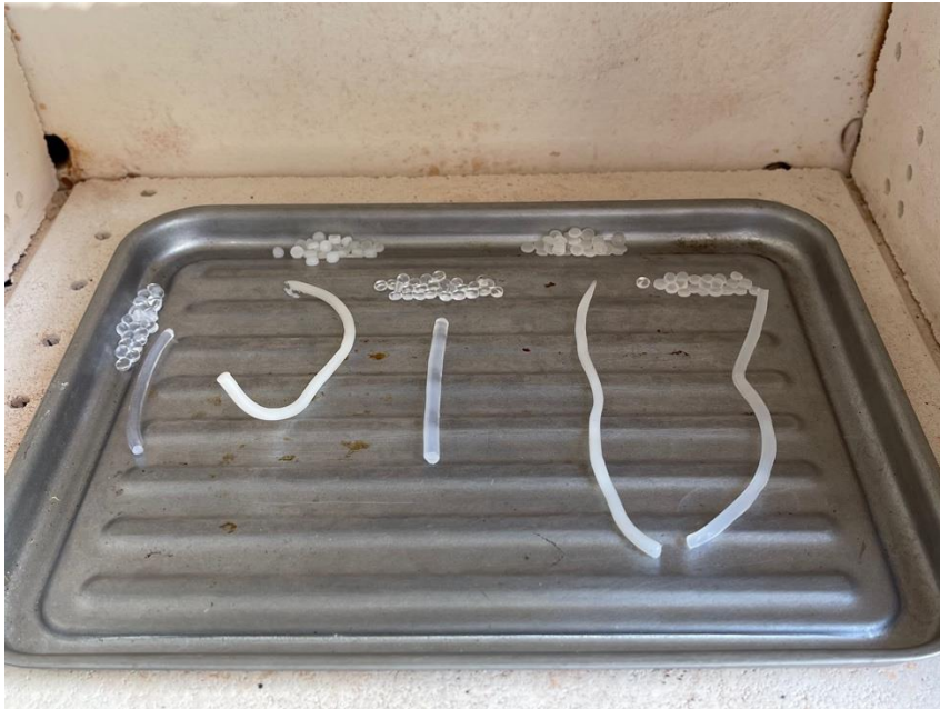
Figura 60. Fotografía de diferentes filamentos a 102 °C
