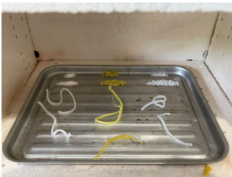
Figura 80. Fotografía de diferentes filamentos a 99°C
