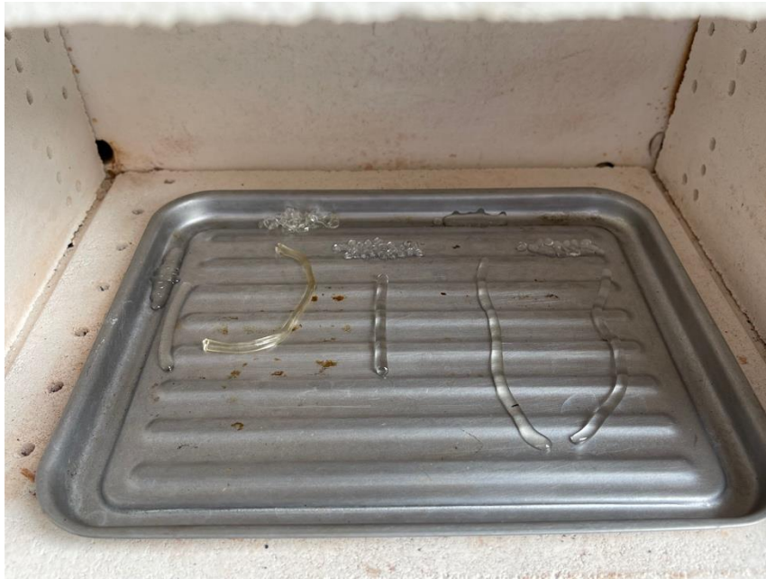
Figura 74. Fotografía de diferentes filamentos a 173°C
