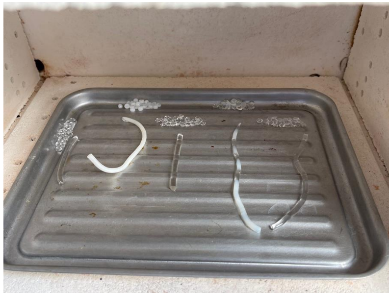
Figura 63. Fotografía de diferentes filamentos a 118 °C
